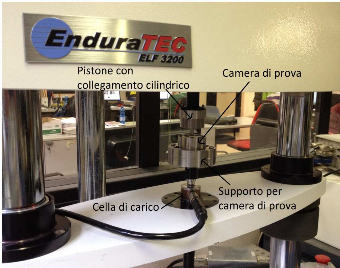
Figura 42 Setup di prova per compressione confinata
