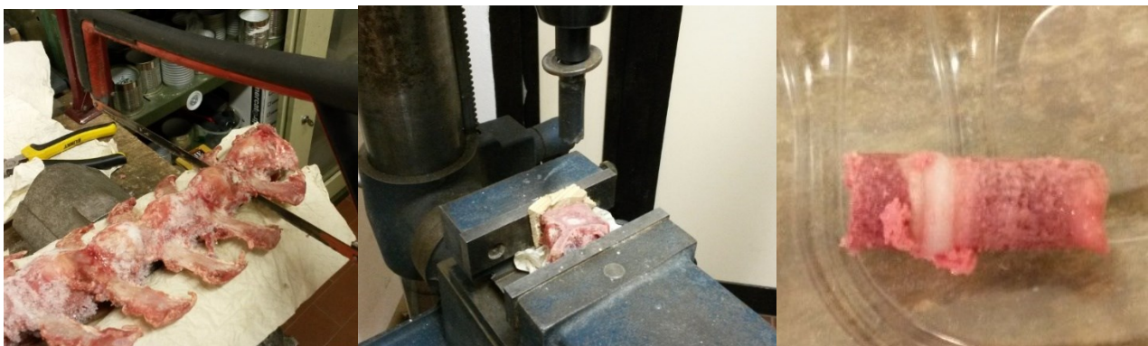
Figura 39 Realizzazione campioni di nucleo polposi: taglio vertebre tramite sega, carotaggio ed estrazione di una porzione di nucleo polposi
