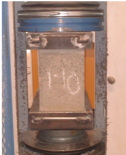
Figura 4.1 Prova di resistenza di compressione del blocco
