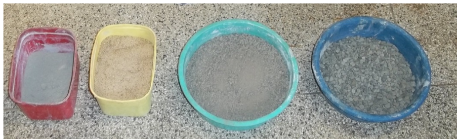
Figura 3.6 Materiali utilizzati nel mix design del calcestruzzo per i blocchi [IZQUIERDO, 2011]
