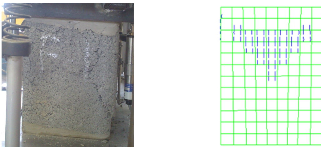
Figura 8.14 Confronto tra il comportamento sperimentale e numerico di un blocco rinforzato, in termini di campo fessurativo sulla superficie laterale trasversale
