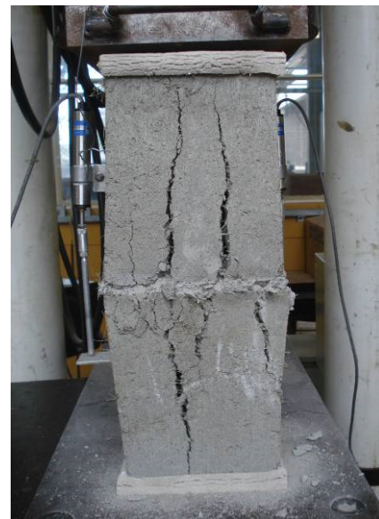
Rottura duttile dei prismi con le fibre
