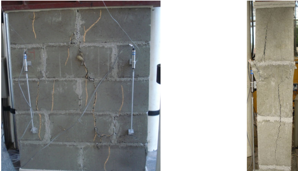
Figura 5.5 Campo fessurativo e rottura delle mini – pareti in calcestruzzo rinforzato(MN 20 – 1%) [IZQUIERDO, 2011]
