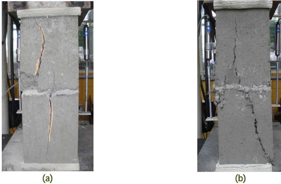
Figura 5.2 Rottura dei prismi (a) senza fibre, PR e (b) dei prismi con l'1% di fibre, PR 20 – 1% [IZQUIERDO, 2011]
