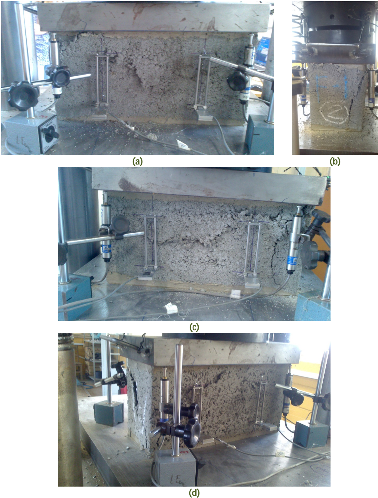
Figura 4.11 (a), (b), (c) e (d) Meccanismi di rottura dei blocchi di calcestruzzo rinforzato all'aumentare dello spostamento imposto
