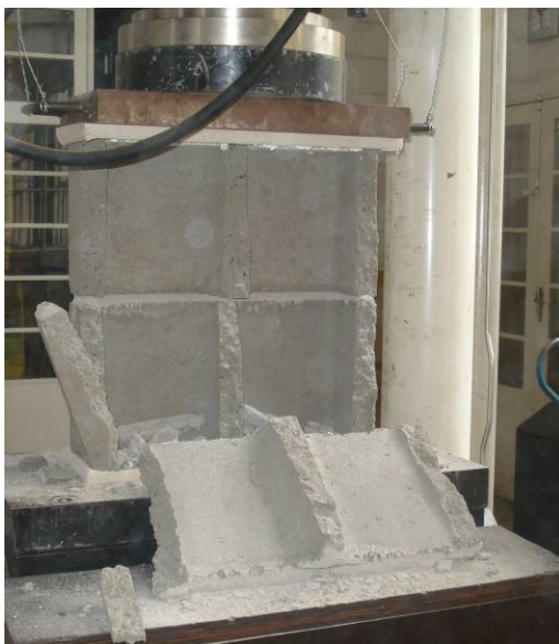
Rottura fragile dei prismi in solo calcestruzzo
