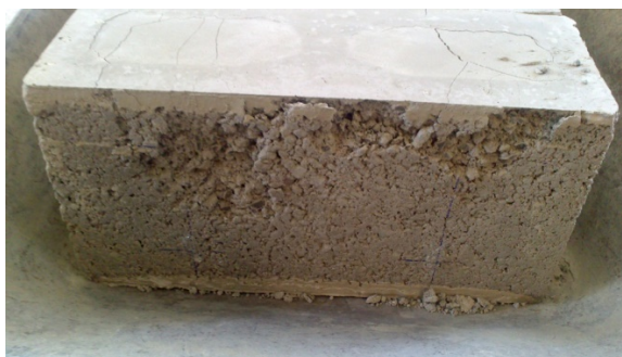
Figura 8.13 Confronto tra il comportamento sperimentale e numerico di un blocco di calcestruzzo, in termini di campo fessurativo sulla superficie laterale longitudinale
