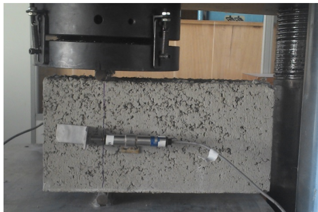
Figura 4.12 Prova di resistenza a trazione indiretta sui blocchi
