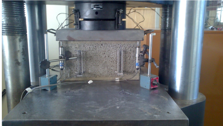
Figura 4.3 Disposizione dei clip – gages e dei trasduttori sul blocco durante la prova di compressione
