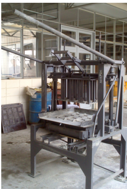
Figura 3.8 Blocchiera Makipen utilizzata per la fabbricazione dei blocchi in laboratorio [IZQUIERDO, 2011]
