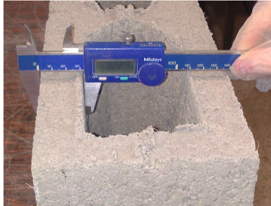
Figura 3.11 Esecuzione dell'analisi dimensionale sui blocchi: (a) misura della larghezza, (b) misura della dimensione interna dei fori e (c) misura dello spessore delle pareti [IZQUIERDO, 2011]
