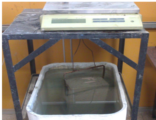
Figura 3.14 Massa dei blocchi determinata per mezzo della bilancia idrostatica [IZQUIERDO, 2011]
