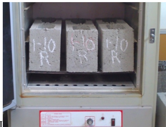
Figura 3.12 Blocchi all'interno della stufa [IZQUIERDO, 2011]
