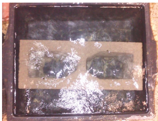
Figura 3.13 Blocchi immersi in acqua [IZQUIERDO, 2011]
