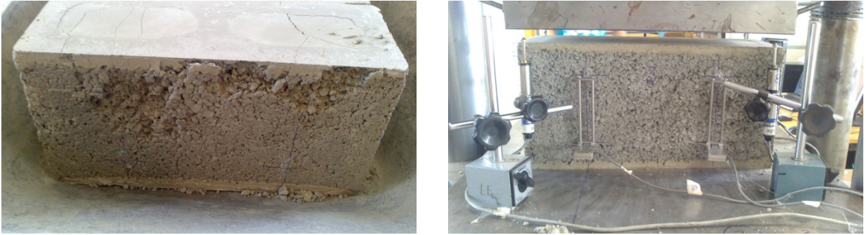
Figura 9.24 Quadro fessurativo a rottura per i blocchi in calcestruzzo
