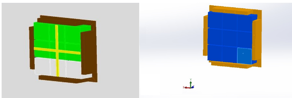
Figura 3.14: Versione in GEANT4 (a sinistra ) e in SolidEdge (a destra ) del LYSO. Nel disegno in GEANT, in grigio si trova il cristallo, in verde il rivestimento in teflon e in giallo , la croce di poron.
