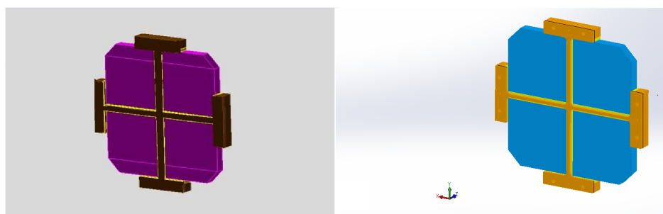
Figura 3.12: Versione in GEANT (a sinistra ) e in SolidEdge (a destra ) del piano replicato per la realizzazione della torre di 15 scintillatori. Si noti la croce in fibra di carbonio di diversa conformazione rispetto a quella del Trigger S2.
