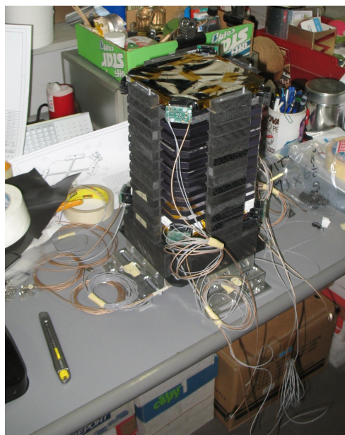
Figura 2.33: Il rivelatore con un fotomoltiplicatore sul primo scintillatore di Trigger.
