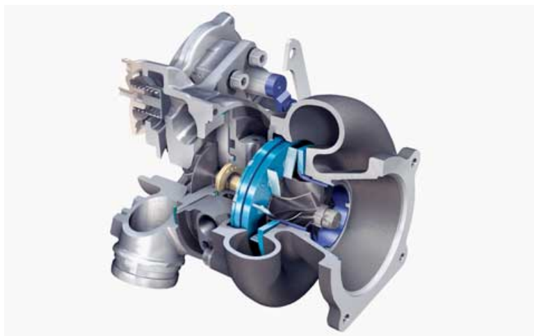
Figura 1.5: Generico gruppo turbocompressore.
