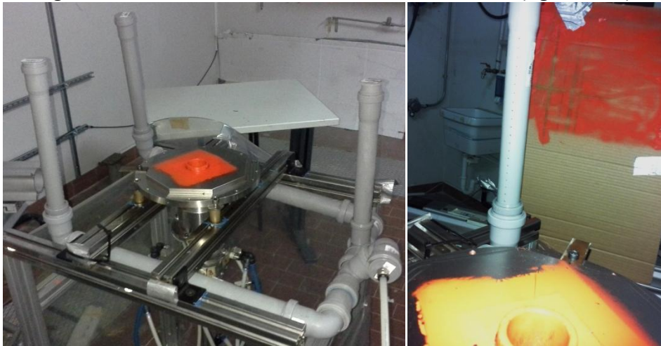
Figura 5.11: circuito esterno di inseminazione posto attorno al bruciatore; nelle tubazioni in plastica sono stati praticati fori di diametro pari a 1.5 mm a distanza di 1 cm l' uno dall'altro, così da ottenere un' inseminazione uniforme attorno al getto.
