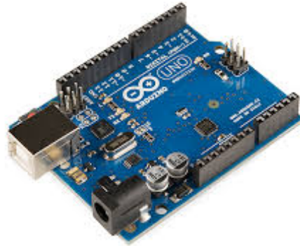
Fig. 2.15: Arduino Uno: una scheda di Arduino
