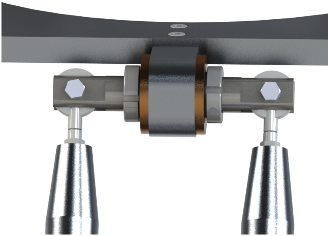
Figura 5.5: Vincolo universale sulla piattaforma
