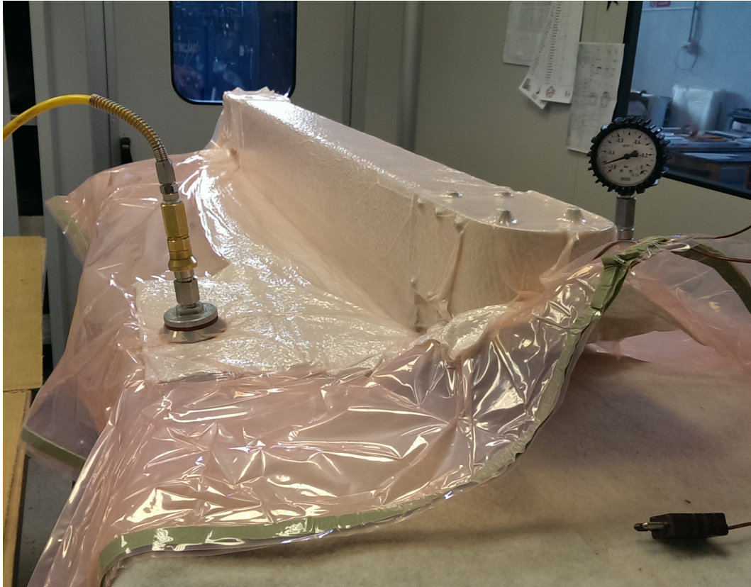
Figura 4.33: Precompattazione con sacco da vuoto
