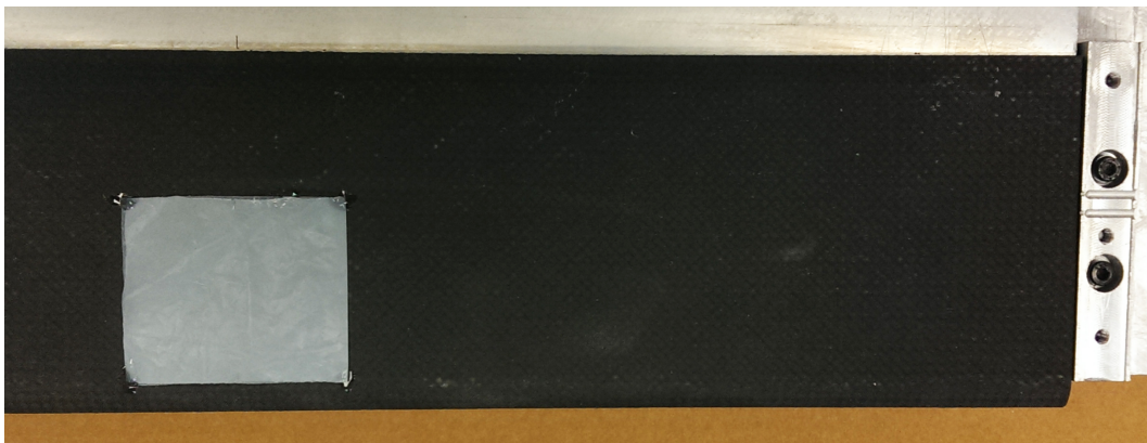
Figura 4.30: Inserimento del difetto di laminazione, doppio lembo di teflon, nella soletta superiore (56 mm x 48 mm)
