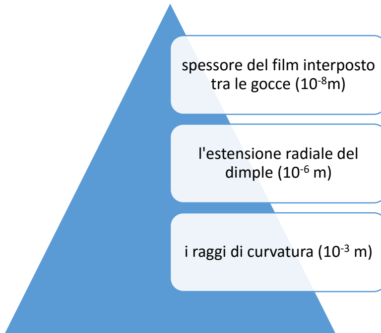
Figura 13: dimensioni caratteristiche del dimple
