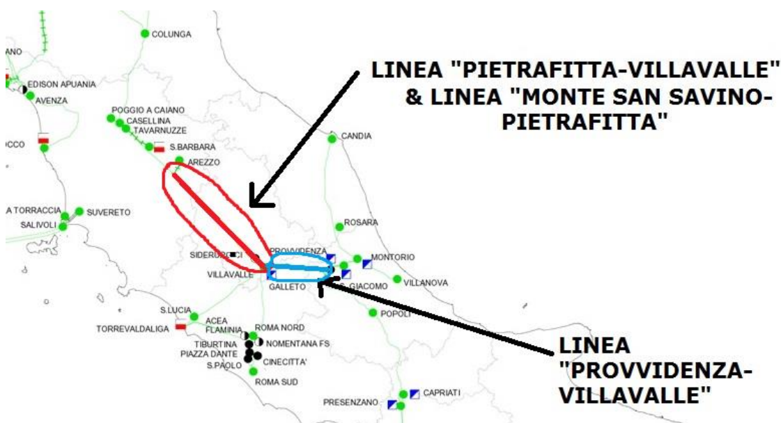
Figura 7.15 Congestione in sicurezza N-1 lungo la linea “Provvidenza-Villavalle” [5]
