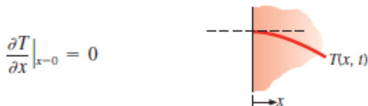
Figura 3.11 Schematizzazione della condizione a gradiente nullo per la temperatura, lungo la coordinata x di una generica superficie [10].
