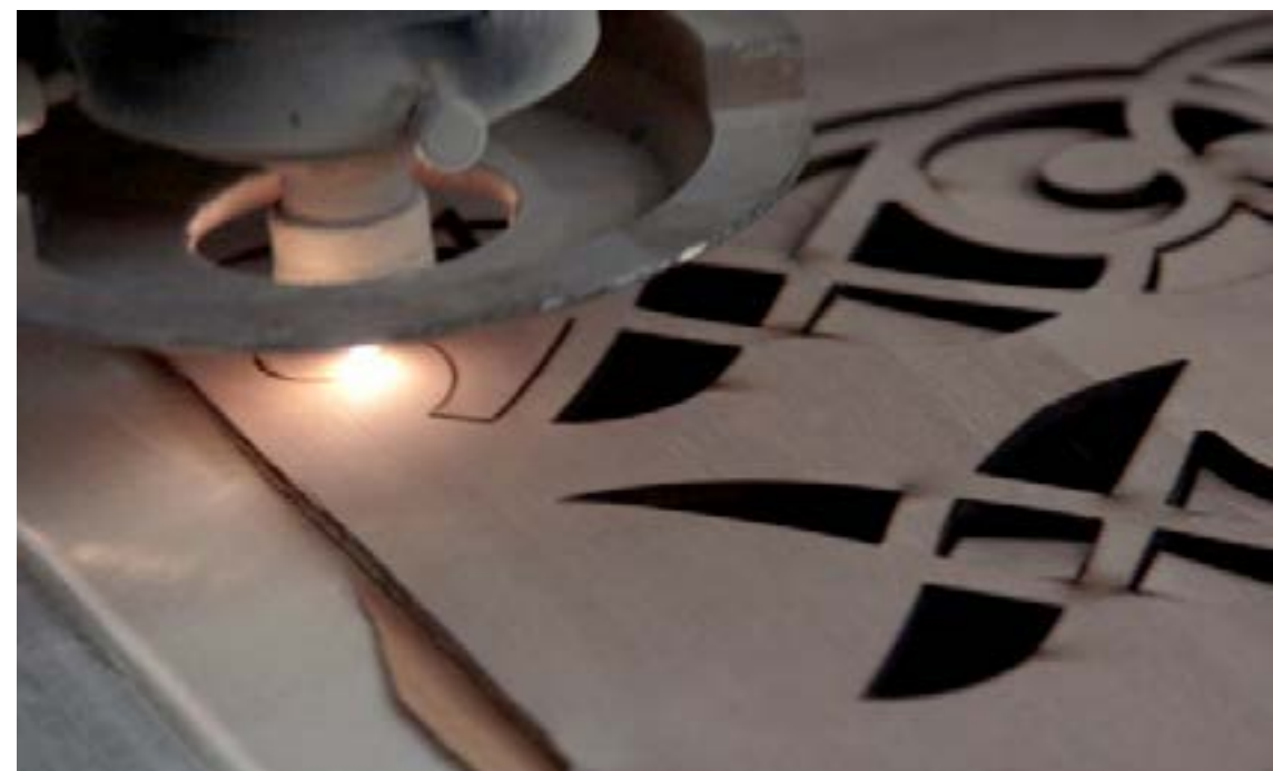
Occhiali da sole tagliati a laser sotto: macchina laser per il taglio del legno in azione
