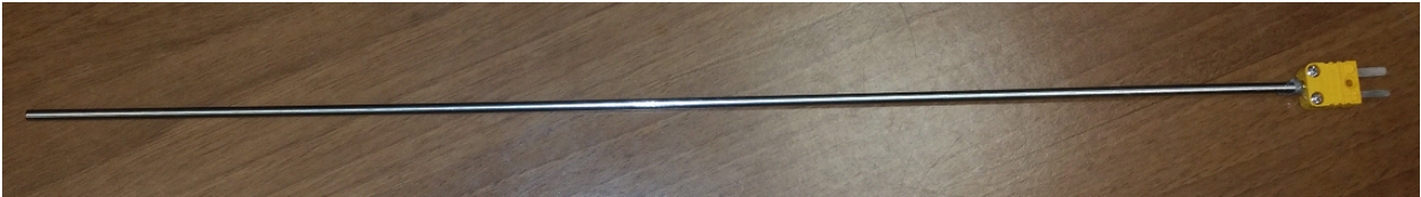
Figura 3.8: Sonda di temperatura nuova per acquisizione a monte statore
