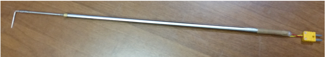
Figura 3.13: Sonda di temperatura a valle dello statore
