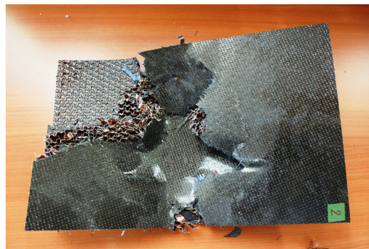
Figura 7.9: Vista frontale del pannello dopo l'impatto.
