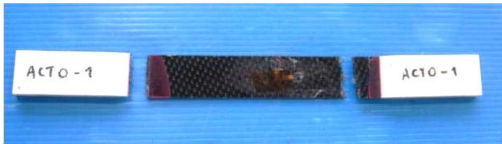
(b) Provino ACT0-1 dopo la rottura.
