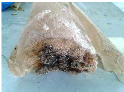
Figura 4.18: Surrogato bruciato dalla scintilla scoccata durante l'impatto.
