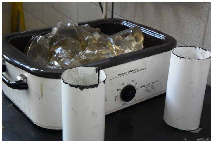
Figura 4.1: PERMAGEL ® pronto per la fusione mediante l'apposito forno.
