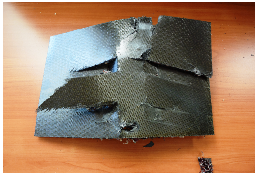
(a) Lato posteriore del pannello sandwich.
