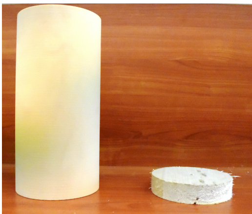
Figura 4.4: Sabot (a sinistra) e strato di balsa (a destra) utilizzati per l'assemblaggio del proiettile.
