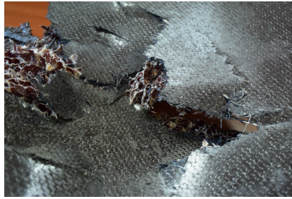
Figura 7.10: Zona centrale del pannello, corrispondente all'area d'impatto. Notare la spaccatura di pelli e riempitivo compattato.
