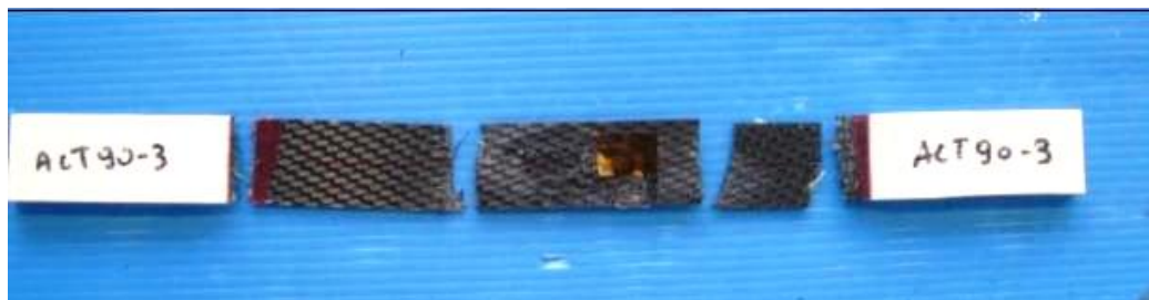
(b) Provino ACT90-3 dopo la rottura.
