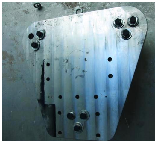
Figura 4.6: Piastra utilizzata per le prove contro bersaglio rigido.
