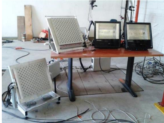
Figura 4.12: Lampade alogene e a led per l'illuminazione della prova.
