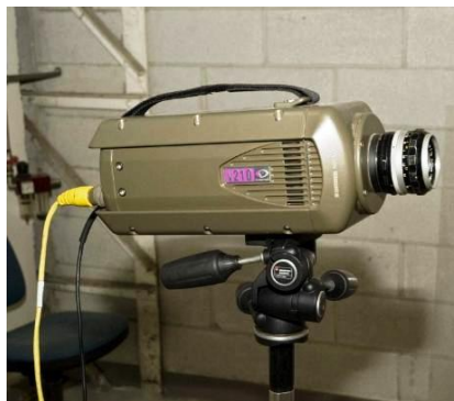
Figura 4.11: Telecamera Phantomv5.1 utilizzata per le riprese ad alta velocità.
