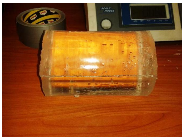
Figura 4.2: Proiettile di forma cilindrica in PERMAGEL ® prima dell'applicazione del nastro adesivo.
