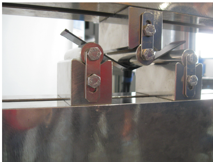
(b) Provino ACF0-2 dopo il cedimento..
