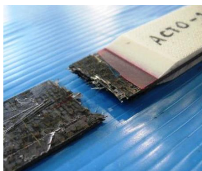
Figura 3.10: Dettaglio sul cedimento del provino ACT0-1 in corrispondenza del talloncino.
