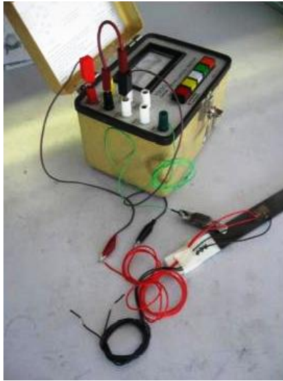
Figura 3.5: Apparecchiatura per il controllo del collegamento elettrico con i sensori estensimetrici.
