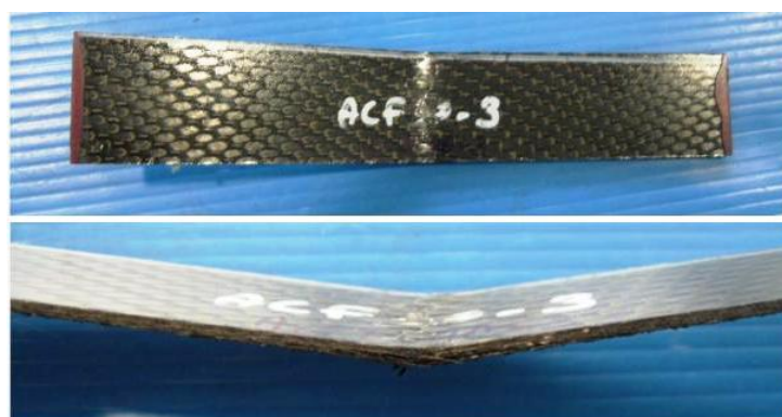
(b) Provino ACF90-2 dopo il cedimento.
