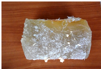
Figura 4.17: Resti del surrogato a seguito dell'impatto.
