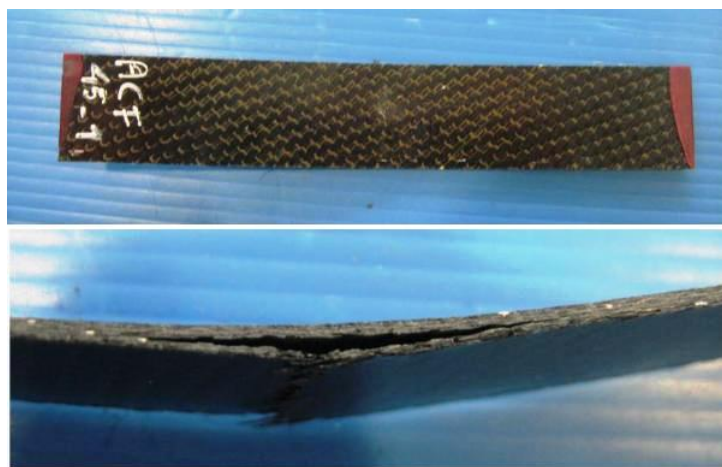
(b) Provino ACF45-1 dopo il cedimento.
