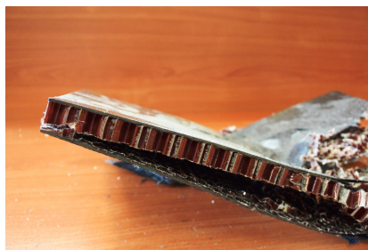
(c) Pelle inferiore distaccata nella zona destra del pannello sandwich.
