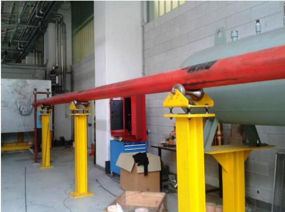
Figura 4.7: Lanciatore utilizzato per le prove contro bersaglio rigido.
