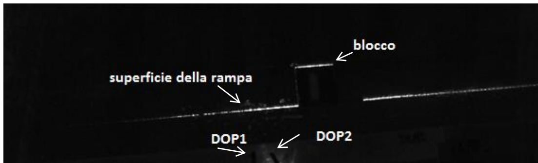
Figura 41: setting dell'esperimento prima del passaggio del fronte d'onda
