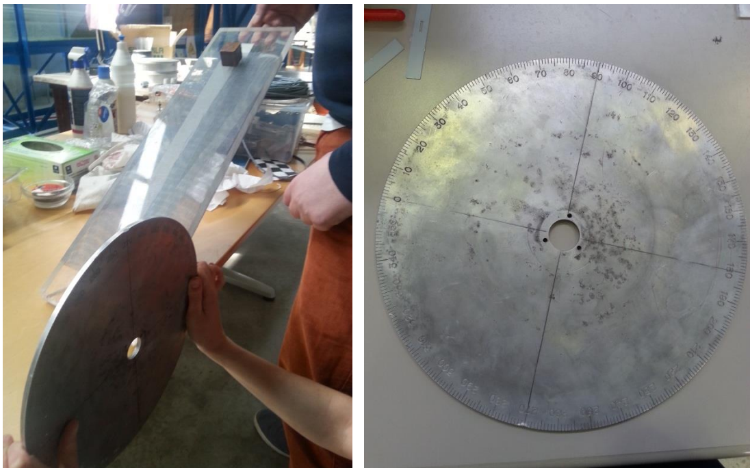
Figura 54: procedimento di misura del coefficiente di attrito
