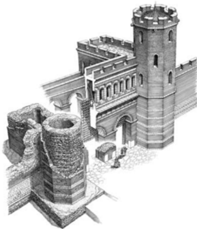
Disegno ricostruttivo della Porta Ticinensis, con spaccato delle fondazioni e dell'alzato.
