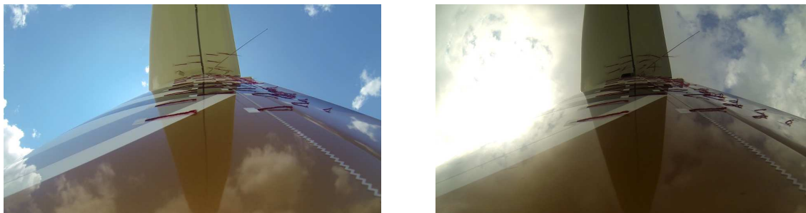
Figura 1.5: Visualizzazioni a fili di lana - Piano di coda
