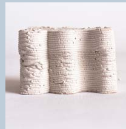
riempimento = 100 %; z hop; spessore di parete = 6 mm
