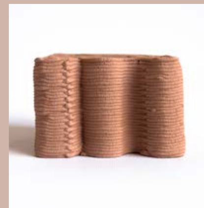
riempimento = 25 %; z hop; spessore di parete = 6 mm
