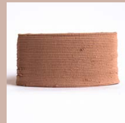
riempimento = 25 %; z hop; spessore di parete = 6 mm
