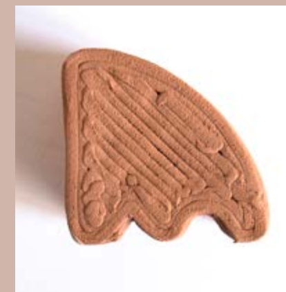
riempimento = 25 %; z hop; spessore di parete = 6 mm
