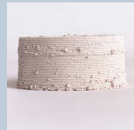
riempimento = 25 %; z hop; spessore di parete = 6 mm
