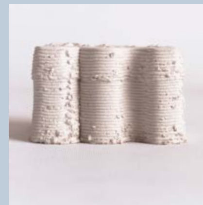
riempimento = 25 %; z hop; spessore di parete = 6 mm
