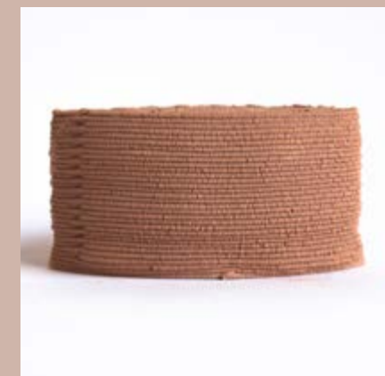
riempimento = 100 %; z hop; spessore di parete = 6 mm
