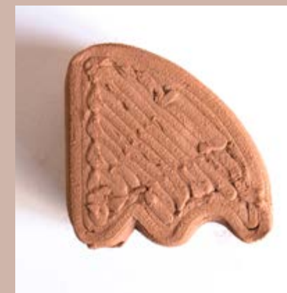
riempimento = 100 %; z hop; spessore di parete = 6 mm
