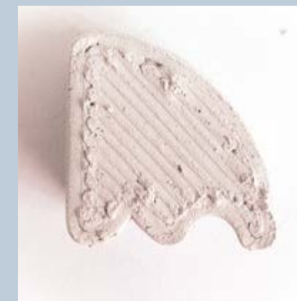
riempimento = 100 %; z hop; spessore di parete = 6 mm
