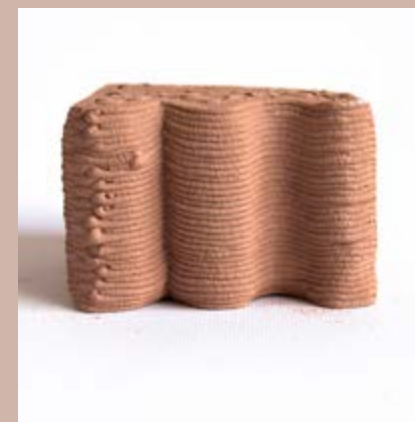
riempimento = 100 %; z hop; spessore di parete = 6 mm
