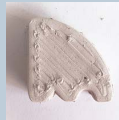
riempimento = 25 %; z hop; spessore di parete = 6 mm
