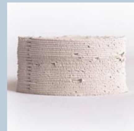
riempimento = 100 %; z hop; spessore di parete = 6 mm
