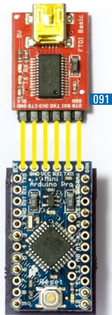
091. Sparkfun FTDI basic breakout è una scheda utilizzata per supplire alla mancanza di una porta usb sull'Arduino mini pro. La sua funzione è quella di mettere in collegamento il microcontrollore con un qualsiasi pc dotato di presa usb, permettendo in questo modo di caricarvi nuovo firmware.
