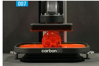
007. La stampante Carbon 3D CLIP costituisce una evoluzione del processo DLP; CLIP è acronimo di Continuous Liquid Interface Production. È stata presentata in veste di prototipo nel 2014 e non è ancora in commercio.
