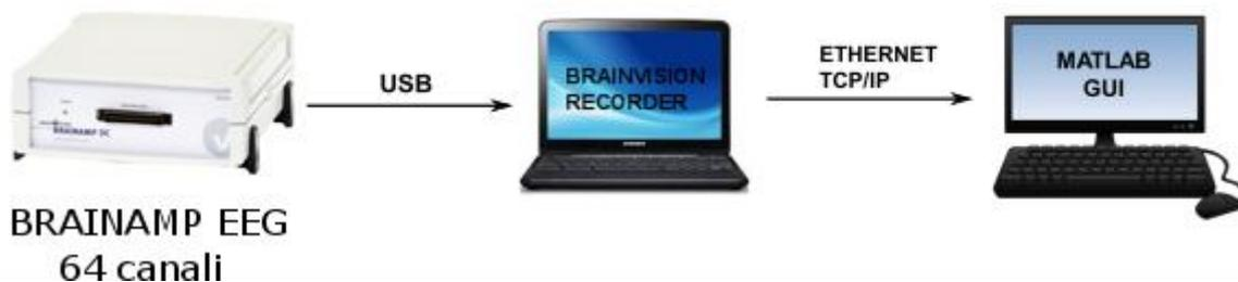
Figura 3.2 Schema del setup hardware utilizzato per la realizzazione della GUI in Matlab.
