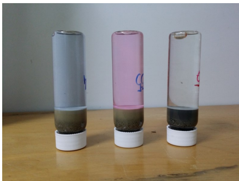
Fig 4.1 - Replicati con additivazione di resazurina per le prove per l'analisi del rilascio del ferro nel tempo
