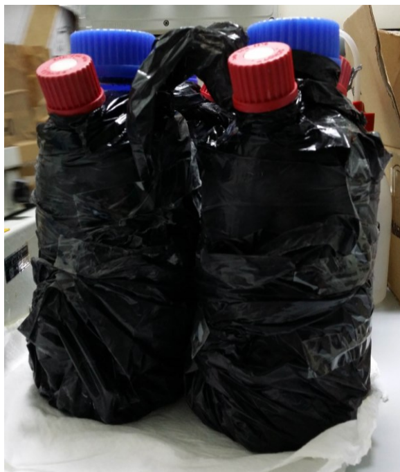
Fig 4.4 - Replicati in bottiglia di vetro compatibile con sistema MARTINA opportunamente schermate dalla luce solare con film nero plastico
