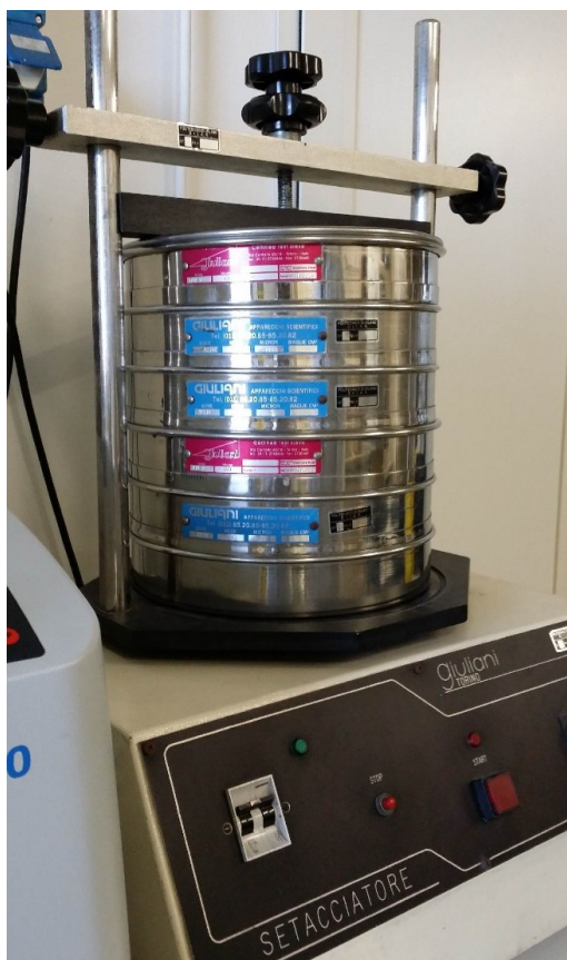
Fig A.6 - Attività di laboratorio- setacciatore con pedana vibrante in funzione per 15 minuti per effettuare l'analisi granulometrica
