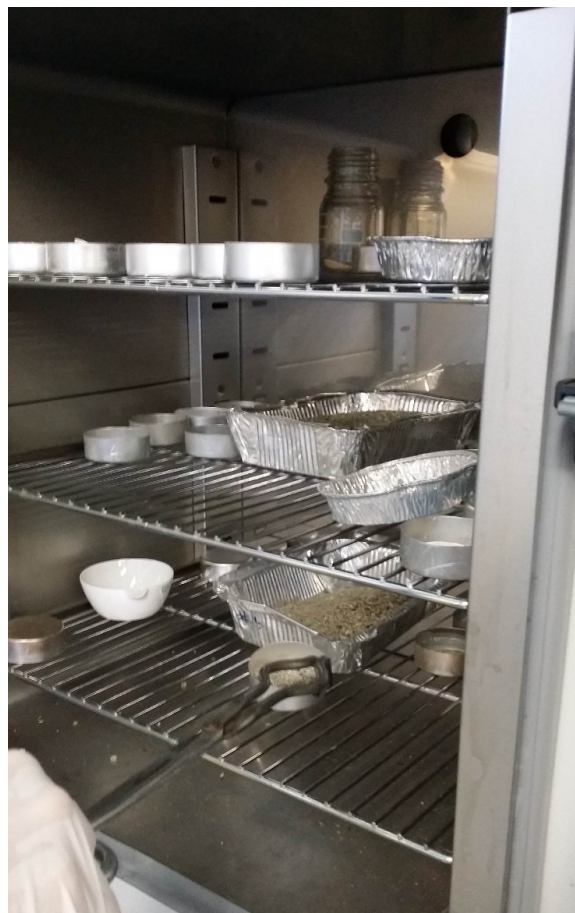
Fig A.1 - Attività di laboratorio- forno per il riscaldamento dei campioni a 105 °C per 24h
