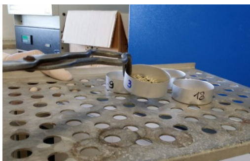
Fig A.2 - Attività di laboratorio- Porta campioni in alluminio (capsule)
