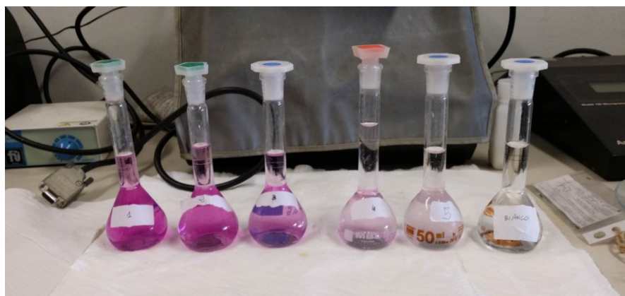
Fig B.9 - Attività sperimentale per la preparazione degli standard reattivi per la tracciatura della retta di taratura
