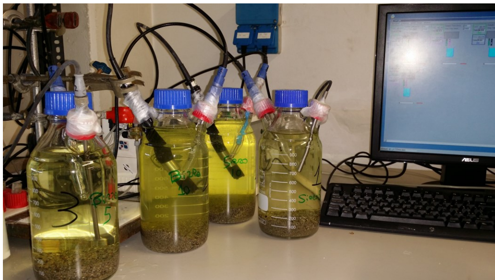
Fig 4.5 - Bottiglie di monitoraggio in vetro collegate al sistema MARTINA
