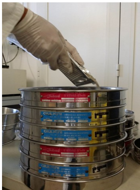
Fig A.5 - Attività di laboratorio- allestimento della prova granulometrica mediante l'utilizzo di setacci posti in serie con luce di passaggio decrescente
