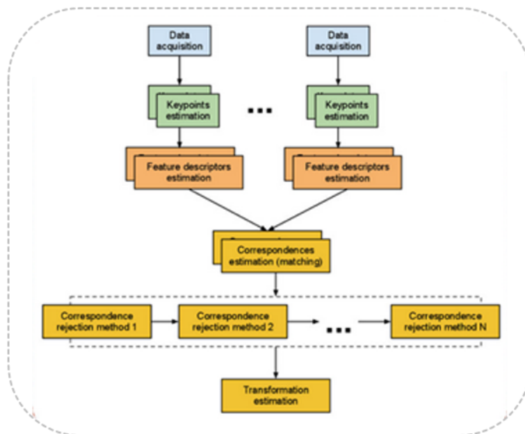
Figura 3.12: Schema della registrazione features based.
