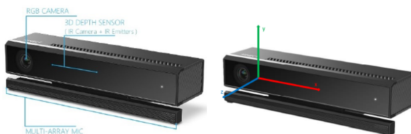
Figura 1.13: Microsoft Kinect V2: componenti nell'immagine a sinistra e sistema di riferimento a destra.
