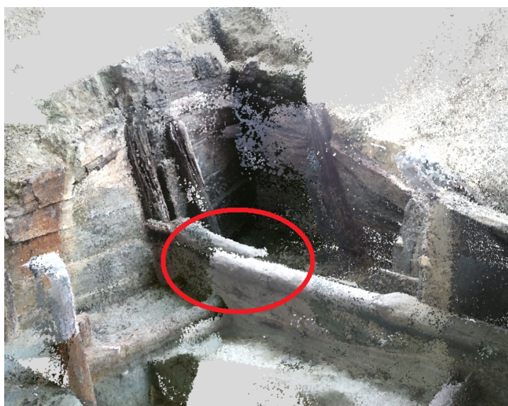
Figura 5.20: Allineamento errato di due nuvole di punti registrate manualmente.
