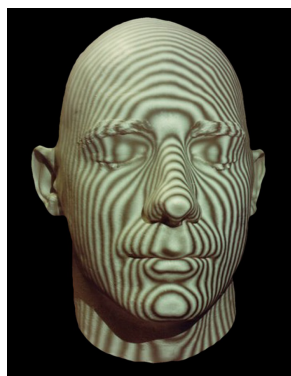
Figura 1.4: Interferometria: proiezione della griglia sul misurando.
