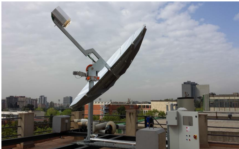
Fig. 4 Disco Stirling installato presso la ETSEIB
