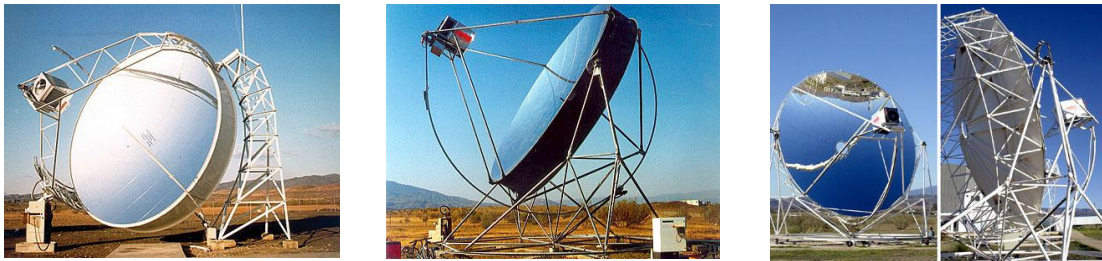
Fig. 5 Dish Stirling serie DISTAL installati presso la PSA [18]
