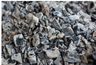
Figura 19. Ceneri da combustione di biomasse.
