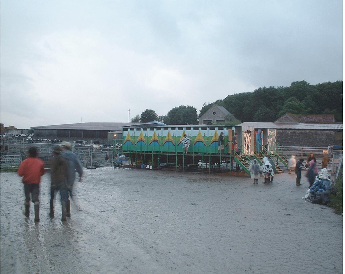
Gli *High Drops* sono wc pubblici dotati di sciacquone, presenti in numero molto limitato e solo in una specifica area del Glastonbury Festival. La struttura in metallo è sopraelevata a cui si accede tramite una scaletta con il serbatoio raccolta liquami sopra il livello del suolo. Gli *High Drops* sono inoltre dotati di una copertura continua in plastica semi trasparente. Ogni blocco di servizi distribuisce otto wc per ogni lato.
