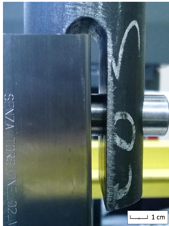
Figura 8.5 - Forcella utilizzata per l'afferraggio dei campioni del "Taglio-piega".
