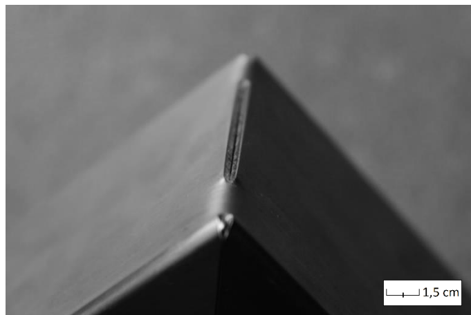
Figura 6.9 - Intaglio realizzato sullo spigolo della piega.
