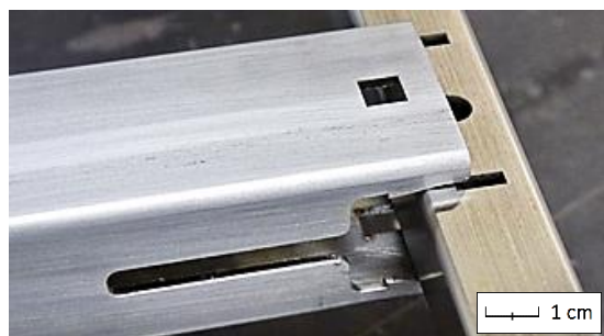
Figura 4.3 - Esempio di unione amovibile di tipo snap-fit.
