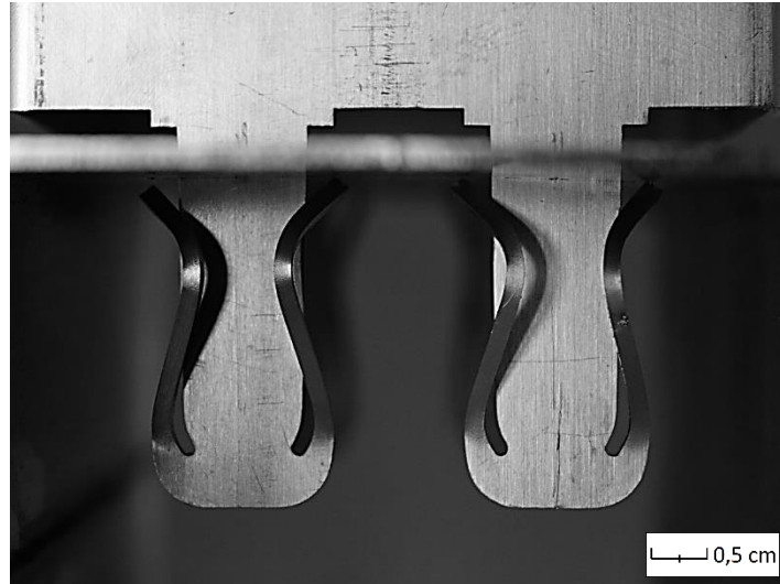
Figura 8.21 - Provino Trap Lock_v5 rotto alla fine del test di trazione.
