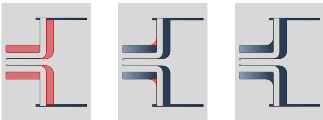
Figura 6.11 - Dettaglio dei passaggi per l'aumento del gap tra l'elemento flettente e la superficie rigida adiacente nelle tre versioni sviluppate.
