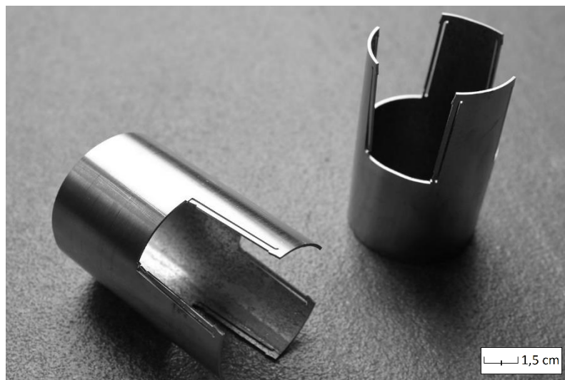
Figura 6.17 - Dispositivo di bloccaggio snap-fit per giunto di testa: Trap Lock_v2.
