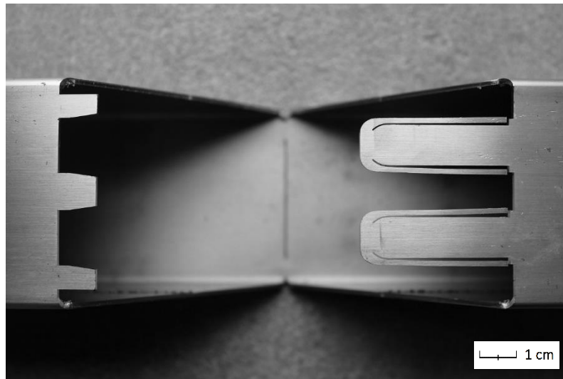
Figura 6.3 - Dispositivo di bloccaggio snap-fit per la tecnica del “Taglio-piega”: Trap Lock_v2.
