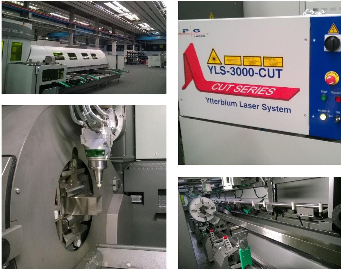
Figura 6.1 - In alto, da sinistra a destra: ADIGE LASERTUBE LT8 Fiber, sorgente in fibra IPG YLS-3000-CUT. In basso, da sinistra a destra: testa per taglio tridimensionale, mandrino robotizzato.
