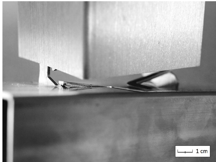
Figura 8.15 - Provino Sede a sbalzo_v3 rotto alla fine del test di trazione.
