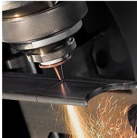
Figura 4.6 - Esempio di taglio laser su di un profilato in acciaio inossidabile. [2.b]
