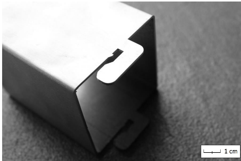
Figura 6.10 - Dispositivo di bloccaggio snap-fit per incastro a T: Sede a sbalzo - SEDE_v2.
