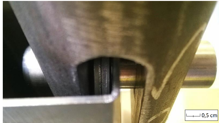
Figura 8.25 - Rondelle posizionate correttamente all'interno del tubolare.
