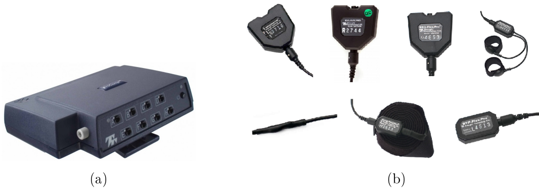
Figura 3.10: Sensore per i parametri fisiologici: (a) Procomp Infiniti, (b) Esempi di sensori disponibili per la Procomp Infiniti: in alto partendo da sinistra abbiamo il sensore per acquisire i dati riguardanti EMG, EKG, EEG e conduttanza della pelle; in basso partendo da sinistra abbiamo i sensori per acquisire temperatura corporea, respirazione e battito cardiaco
