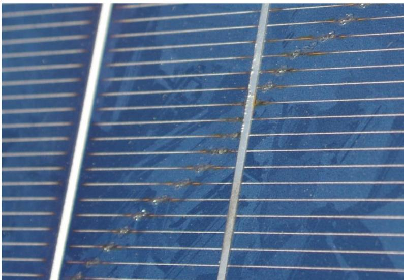
Figura 5.3: fingers con segni di bruciature lungo una microfrattura
