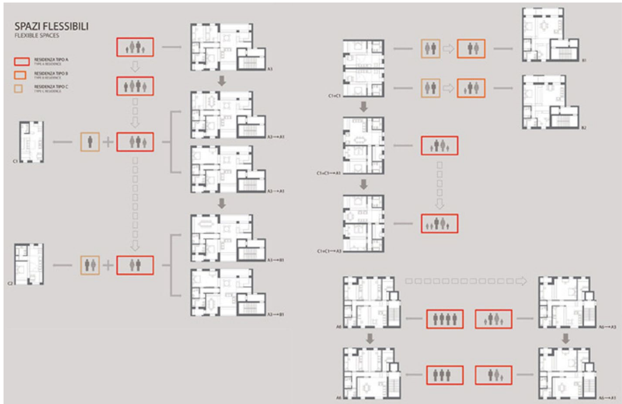
Fig.2.2.50: Concorso Una Comunità per crescere (Milano - via Cenni) - Progetto dell'Arch. Davide Francesco Roth: Schema della flessibilità dei vari alloggi
