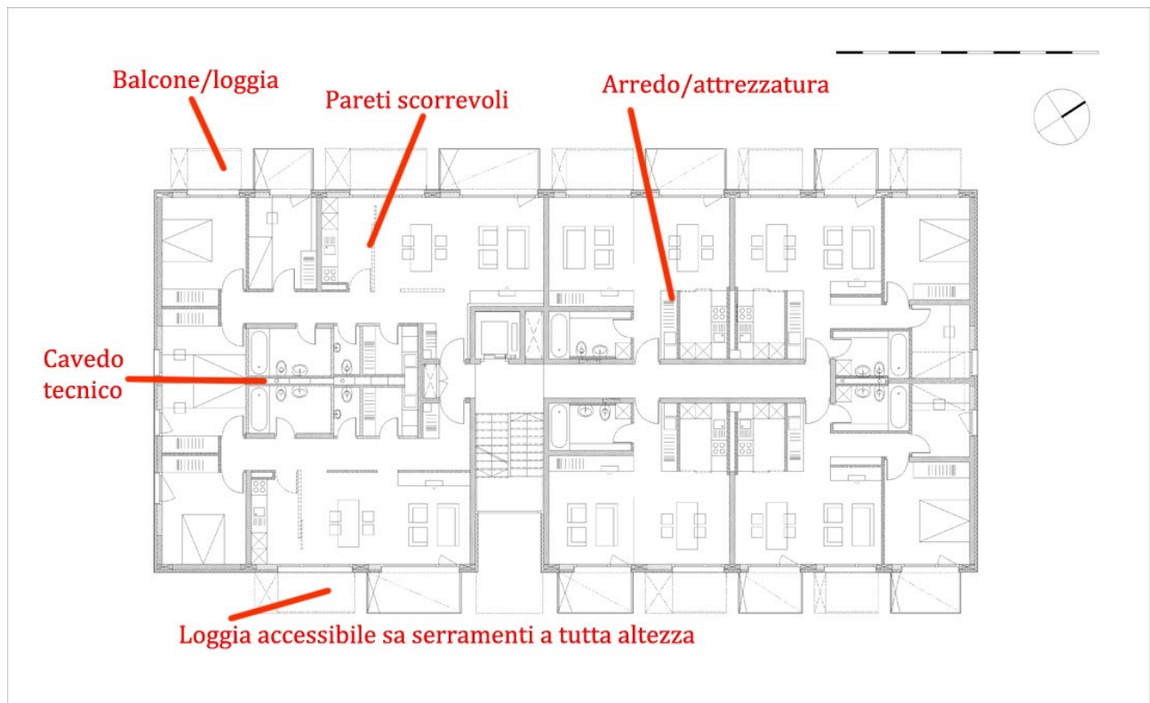
Fig.2.2.60: Pianta del piano terra n cui vengono segnalati alcuni elementi generatori di “flessibilità”. Fig.2.2.61: OFIS, Honeycomb, Izola, 2006. Pianta primo piano in cui vengono segnalati alcuni elementi generatori di “flessibilità”.
