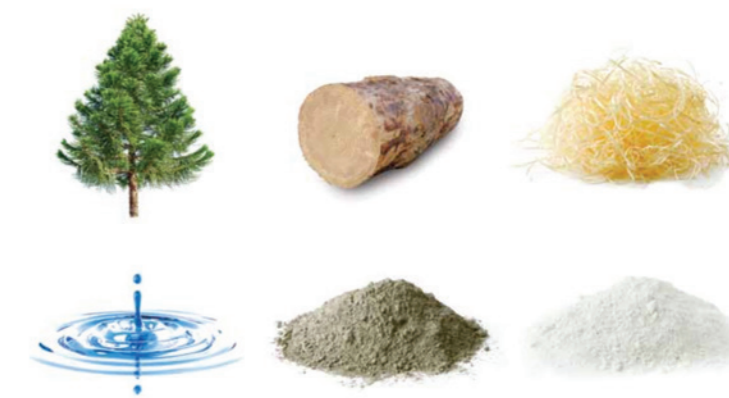
Figura 6.8 Composizione degli isolanti Celenit
