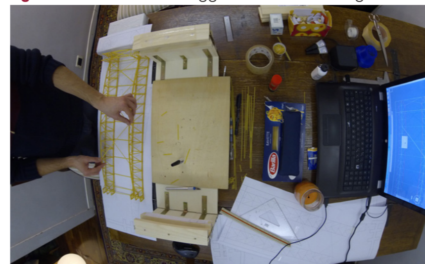
Figura 8.22 Fase 7: unione delle due travi
