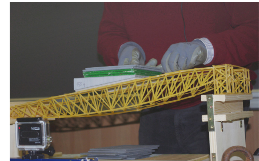
Figura 8.32 La prova di carico: il cuneo sostiene le piastre
