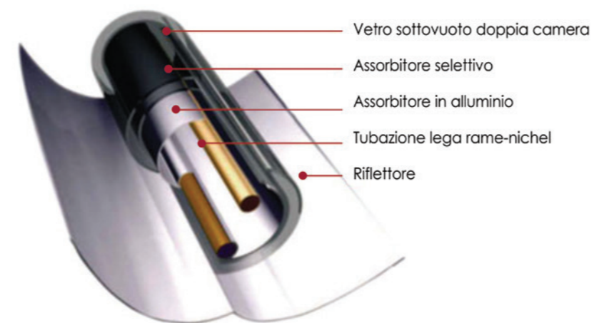
Figura 7.55 Struttura dei pannelli solari sottovuoto
