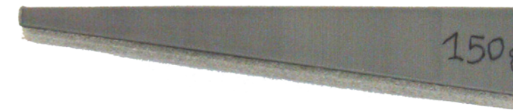
Figura 8.28 Il cuneo stampato in 3D: vista laterale. Si noti lo strato morbido incollato nella parte inferiore
