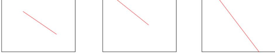
Figura 2.1: In ordine una frattura immersa, una parzialmente immersa e una che attraversa il dominio.
