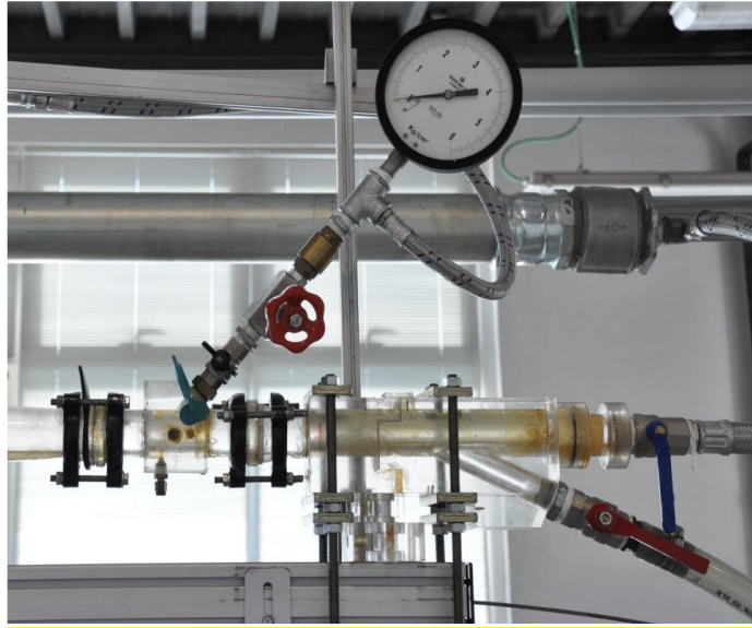
Figura 2.12-SISTEMA DI INIEZIONE FLUIDI DI LAVORO
