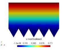
(d) Wall-normal component  $\bar{v}_r$ . Triangular grooves d = 0.1.
