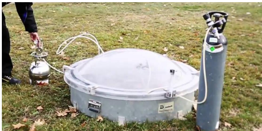
Figura 5 – Camera di ventilazione
