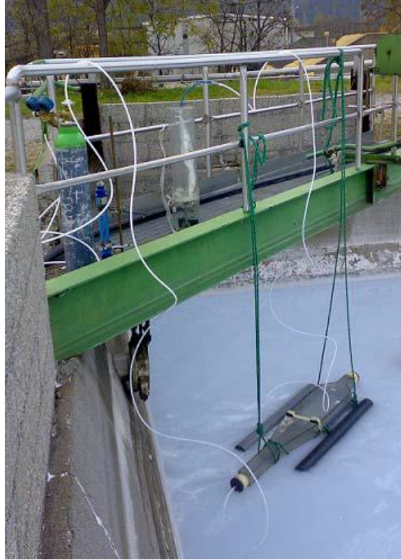
Figura 6 – Prelievo da sorgente areale passiva
