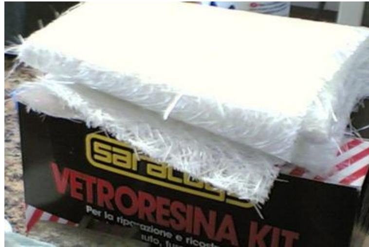
Figura 2.2.3 - esempio di polimero termoindurente: la Vetoresina, ovvero resina epossidica rinforzata con vetro
