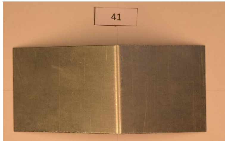
Figura 5.1.8 - provino spesso 0,7 mm piegato con matrice con inserto in Necuron 1050
