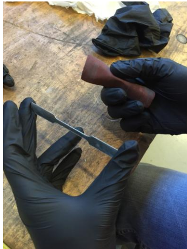
Figura 4.3.8 - provino con bordi corretti
