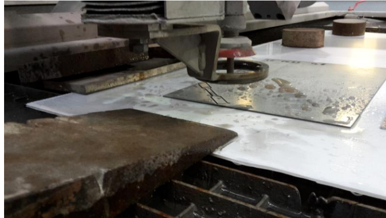
Figura 4.3.4 - Lavorazione in atto per il taglio dei provini da trazione/anisotropia
