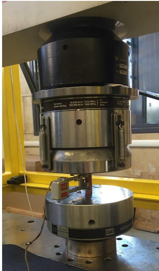
Figura 4.2.9 - configurazione con provino tra le piastre e compressometro montato
