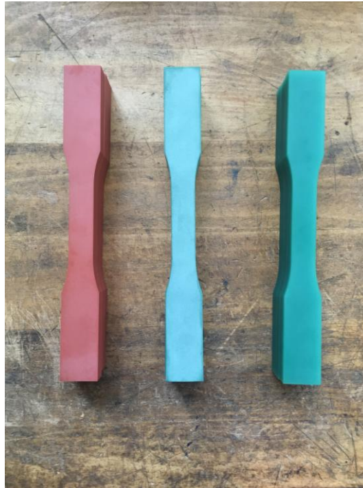
Figura 4.2.2 - provini per prova di trazione ( in ordine da destra a sinistra: Necuron 1300, Necuron 1050, Necuron 1150)
