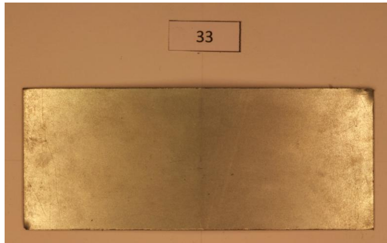
Figura 5.1.6 - provino spesso 0,7 mm piegato con matrice con inserto in gomma forata
