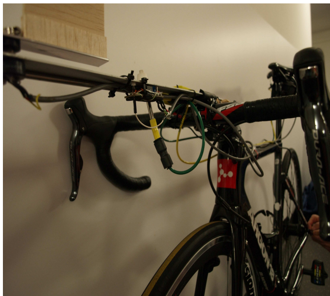
Figura 1.10: Zoom interruttore di accensione e spegnimento della registrazione
