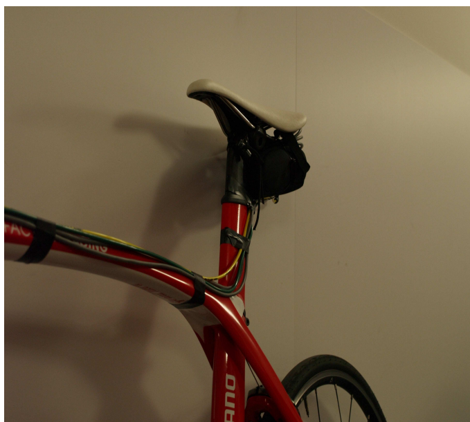
Figura 1.11: Sistemazione datalogger arduino e fissaggio cavi
