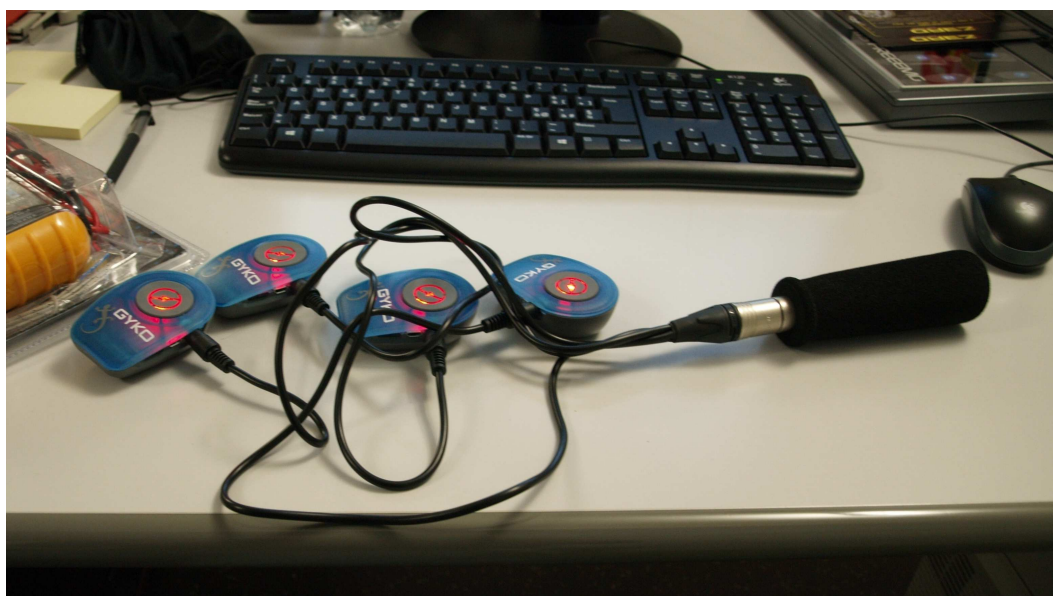
Figura 1.12: Sensori Gyko durante la fase di trimmatura esterna
