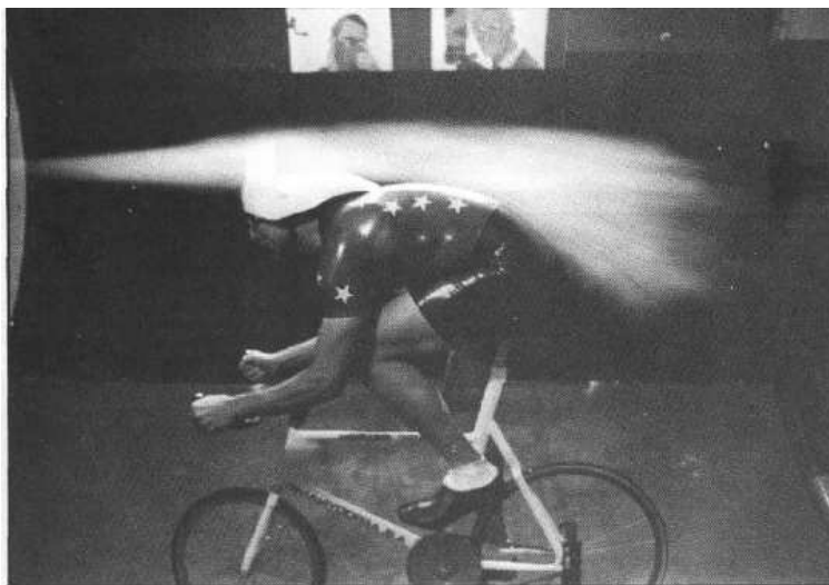
Figura 11: Prova in galleria del vento con visualizzazione della componentistica utilizzata dal team statunitense nel 1984. Immagine modificata tratta da Cycling science , Dicembre 1989
