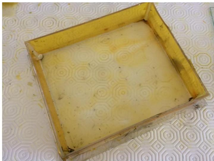
**Figura 75 - Vat con fondo in PDMS sottoposto alle sperimentazioni**
