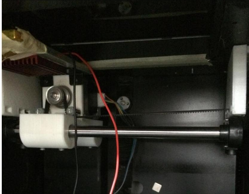
Figura 26 - Sistema di movimentazione omega drive
