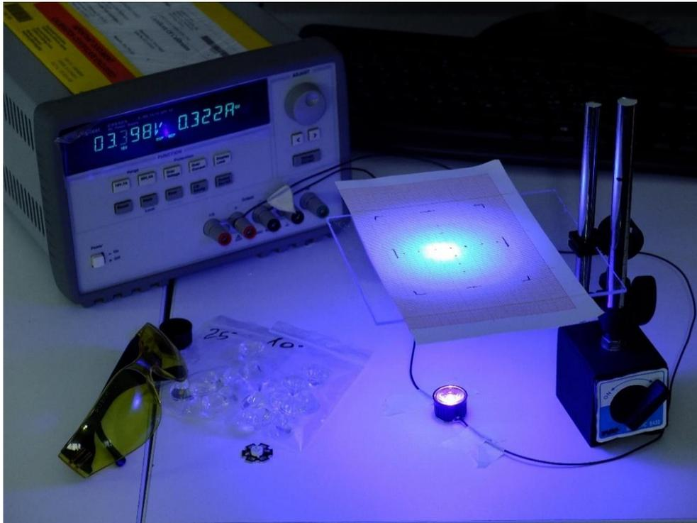
Figura 40 - Sistema per la sperimentazione della distanza dal LCD e della lente ideale per l'applicazione richiesta
