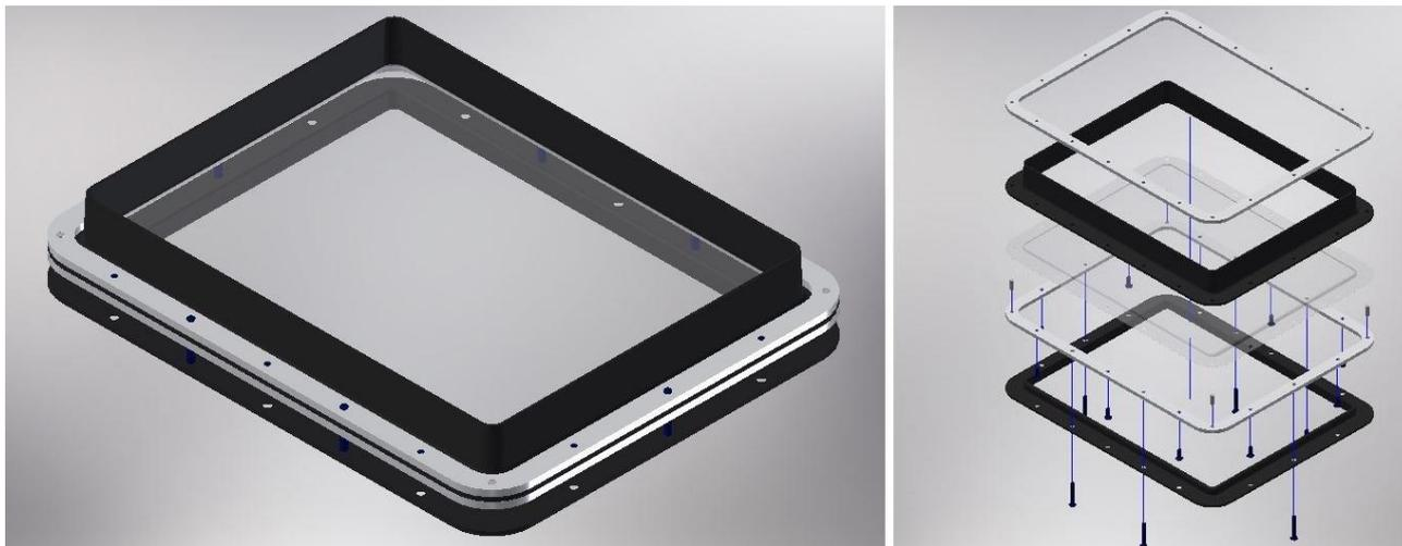
Figura 76 - Vista assemblata ed esplosa del sistema vat
