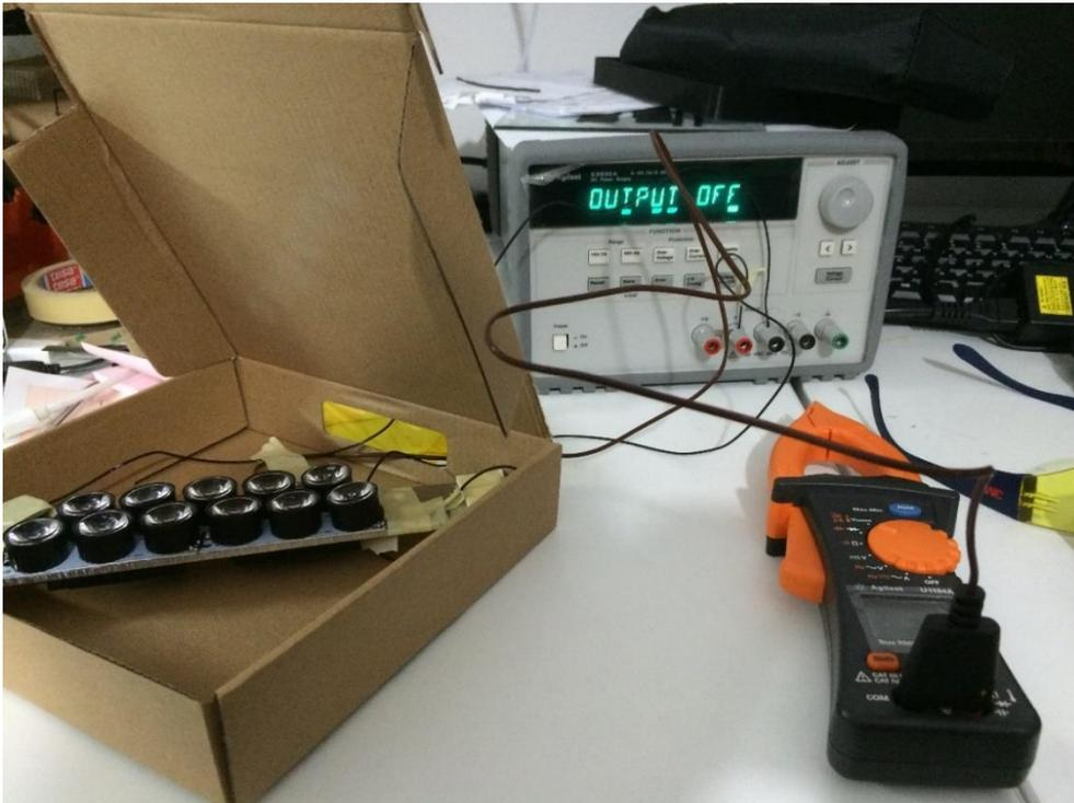
Figura 35 - Sistema di sperimentazione per la misura della temperatura dell'array di LED
