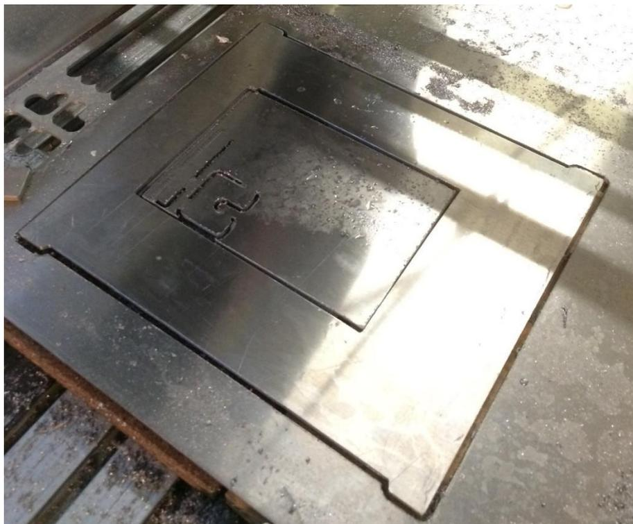
**Figura 80 - Lamiera in alluminio fresata per ottenere componenti del prototipo fisico**
