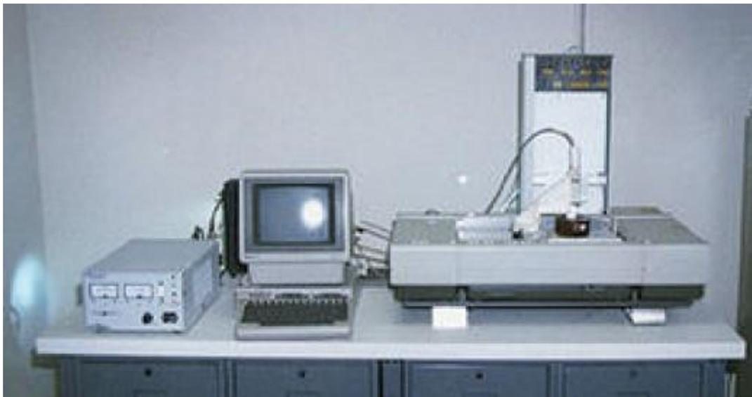
Figura 1 - Il primo apparato stereolitografico sviluppato da Charles Hull
