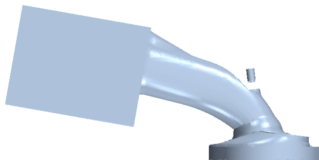
Figura 4.3: Rappresentazione del plenum a monte dell'aspirazione
