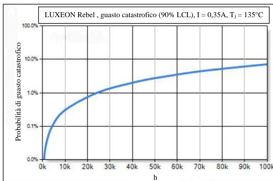
Figura 3.2 – Risultati della simulazione per guasto catastrofico del LED LUXEON Rebel (Philips Lumileds) nelle condizioni operative I = 0,35A , T_j = 135^{\circ}C . È rappresentato il limite di confidenza inferiore, per una confidenza del 90%.
