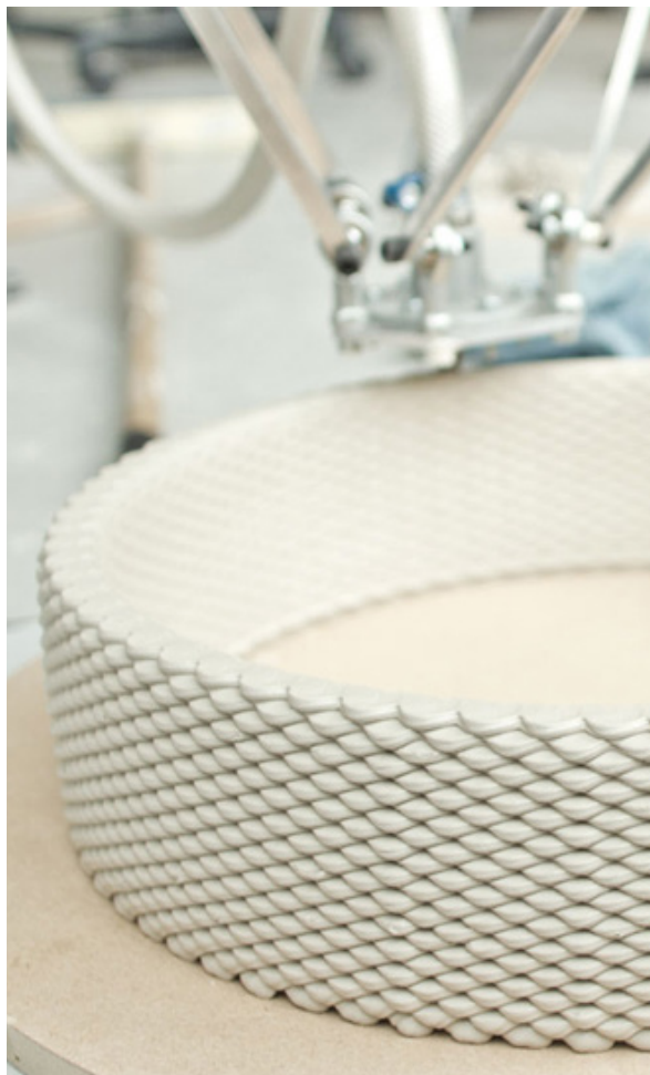
132. Stampa 3D con filamenti di ceramica
