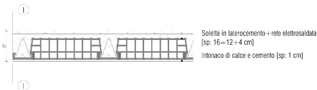
Figura 13. Partizione orizzontale sottotetto
