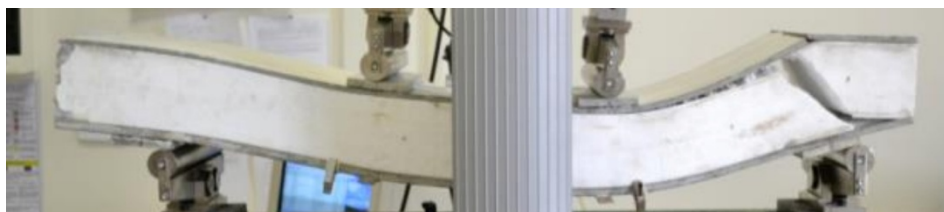
Figura 13. Rottura del provino B4: formazione di una fessura di taglio nell'EPS.
