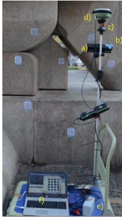
Figura 39 Carrellino di 4 ruote su cui poggiano f) laptop e batteria e). Ed a cui è stata fissata la palina tramite legacci. Sulla pallina troviamo a) il sensore Kinect b) il sensore U-blox c) il prisma ed infine l'antenna GPS a doppia frequenza.
