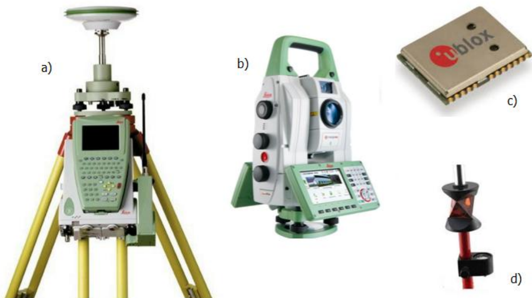
Figura 38 a) Il ricevitore a doppia frequenza GPS LEICA GS14 con apposito treppiede b) Multistation LEICA MS60 c) Sensore GPS miniaturizzato U-blox. d) prisma LEICA.
