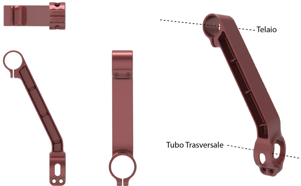
Figura 59: Render – Congiungente telaio centrale/Tubo trasversale
