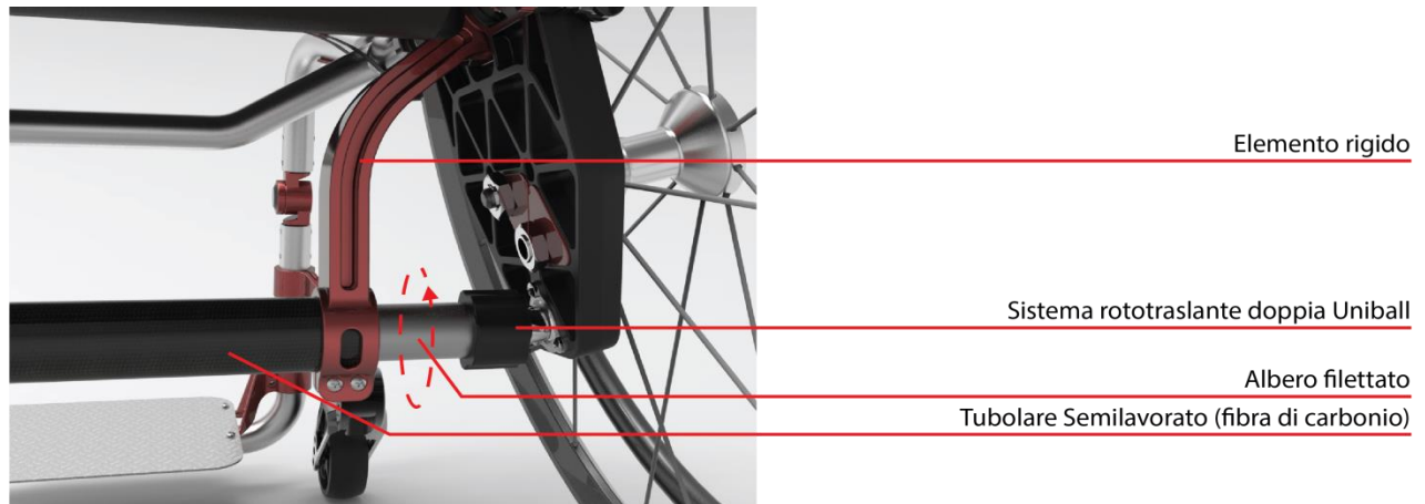
Figura 62: Render – elementi del sistema di regolazione dell'angolo delle ruote
