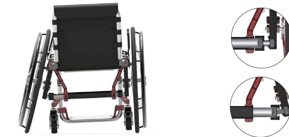
Figura 35: Render – Regolazione camber
