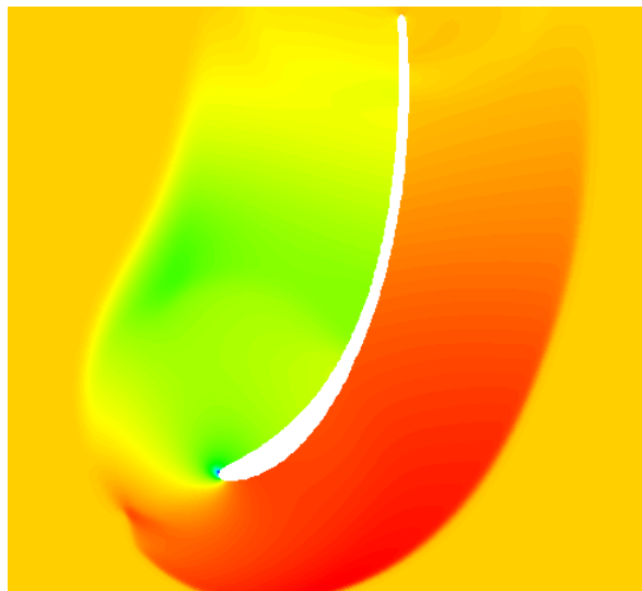
Figura 3.7: Campo di Pressione attorno al profilo palare
