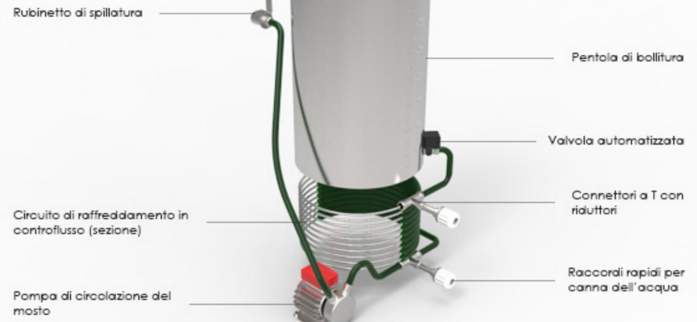
La terza parte è quella idraulica, composta da pentola e sistema di raffreddamento in controflusso.
