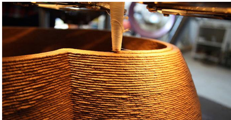
Figura 5.2 Particolare di una stampante 3D della Wasp durante la deposizione di argilla
