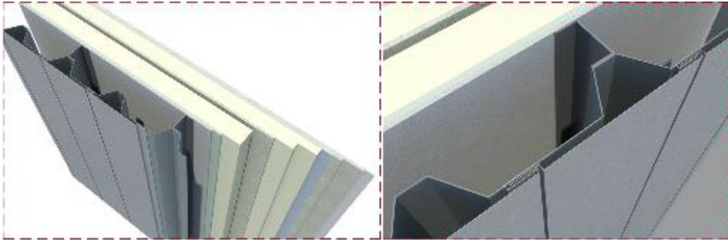
Fig. 123 - Disegno tridimensionale della chiusura verticale con rivestimento in Tecu Zinn
