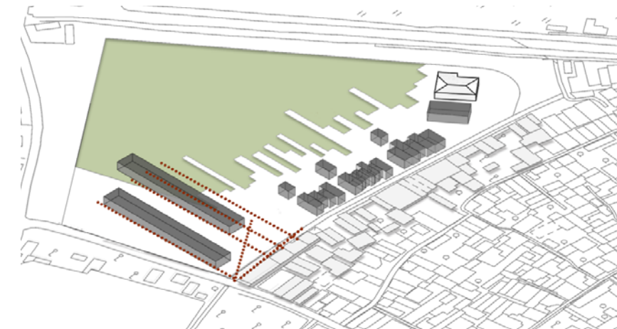
9.VOLUMI MERCATO: distribuzione dei due differenti volumi di progetto all'interno degli assi precedentemente tracciati, per la riqualificazione del precedente mercato fatiscente.
