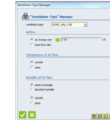
Figura 6.75 Schermata ventilazione interna fissaTrnbuild
