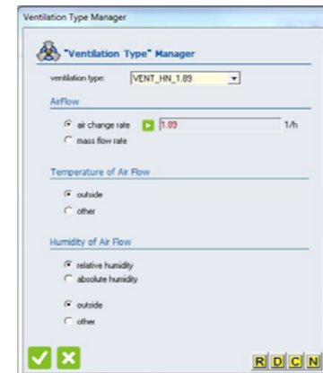
Figura 6.40 Schermata ventilazione fissa Trnbuild
