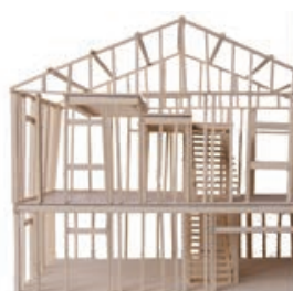
Modello struttura interna platform
